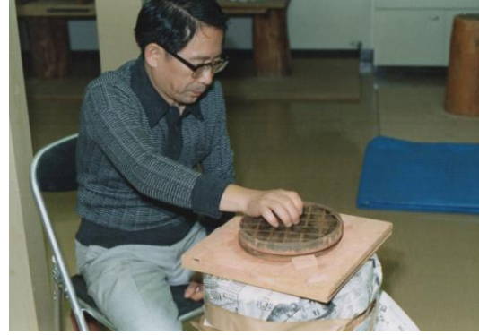
写真 10 凹面鏡ピッチ整形研磨 中村和幸
