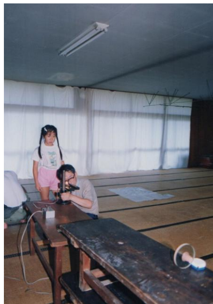
写真8 フーコーテスト・影の試験 右手前は 10cm 鏡・中村和幸
