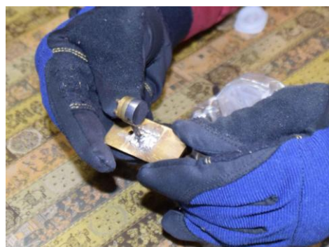
写真 6 副鏡と取り付け金具 (副鏡は回転球面)
