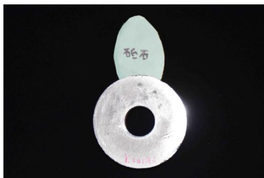
写真 24 模型楕円砥石上の研磨方法 (固定砥石と鏡前後運動の模様)
