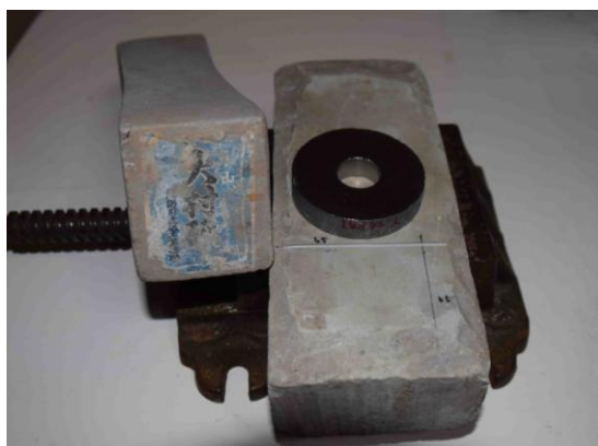
写真 22 仕上砥石(中央)とレプリカ鏡 (切り出し前の内曇砥石 左は荒砥石)
