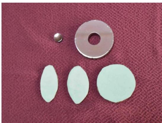
写真 21 砥石模型とレプリカ主・副鏡 (楕円砥石を使用して研磨)
