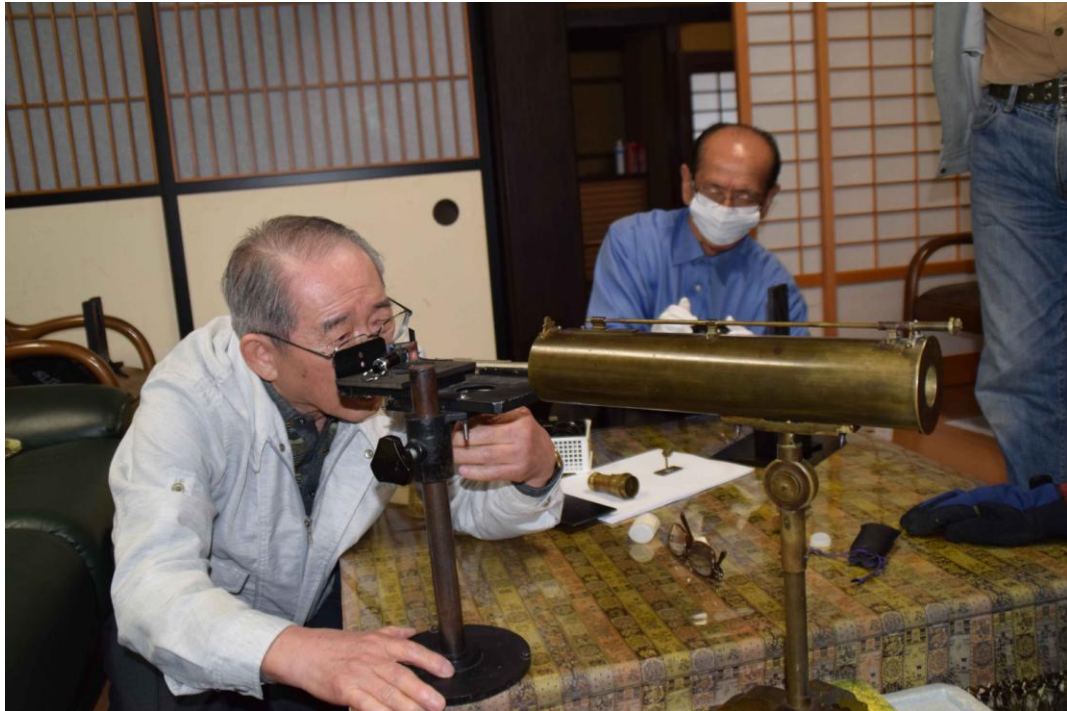
写真 9 中村和幸による国友 4 号主鏡のフーコー試験（主鏡は内装保持）
