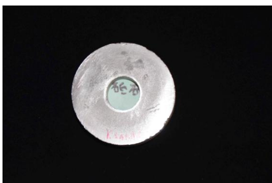
写真 23 模型砥石上のレプリカ鏡 (下側の楕円砥石と金属鏡材料)
